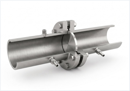
D-D/2 Tap ภาพตัดเพื่อช่วยให้เข้าใจ แท็ป D-D/2 (Radius Tap) — วัดที่ผนังท่อ ต้นน้ำ 1D · ปลายน้ำ D/2 ภาพตัด
